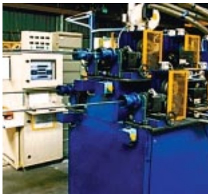
Вихретоковый контроль проволоки
