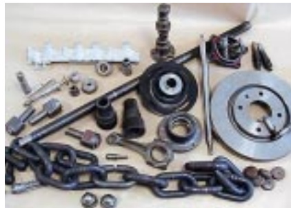
Автомобильные детали, контролируемые с помощью Eddyscan® 30X TM
