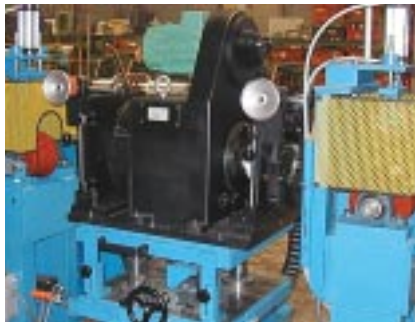
Вихретоковый контроль продольных дефектов прутка
