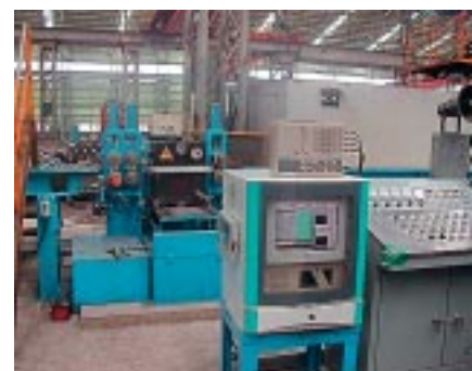
Вихретоковый контроль труб
